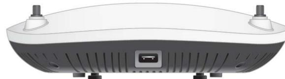
Quando alimentada por uma fonte 802.3at ou CC (DC), a porta USB pode fornecer energia de até 5 W.
